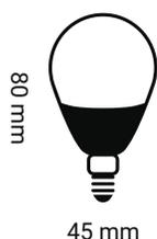
Secondo attacco più usato, è un classico attacco piccolo con un diametro di 14 mm. Le lampadine E14 hanno un consumo energetico ridotto e sono tipicamente progettate per l'illuminazione di design e decorativa, per lampade e lampadari, cappe da cucina, ecc.
